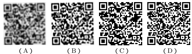
図 2 (A) は動画の初期フレーム (B) は超解像処理を行った画像 (C) は (B) から推定した QR コード画像 (D) は正解 QR コード画像
